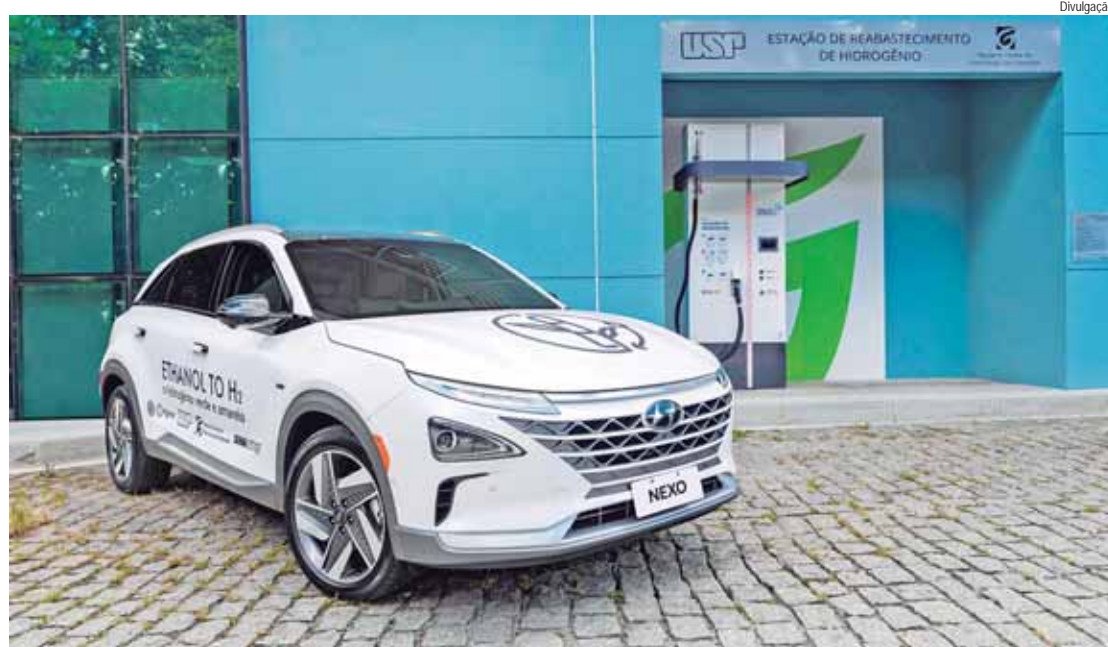
Veículo movido a hidrogênio oferece 163 cv de potência combinada entre a célula de combustível e o motor elétrico, com autonomia de mais de 660 quilômetros
