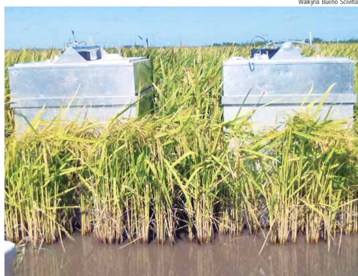
Uso de câmaras estáticas para monitoramento de emissões de gases de efeito estufa em sistemas de cultivo de arroz
