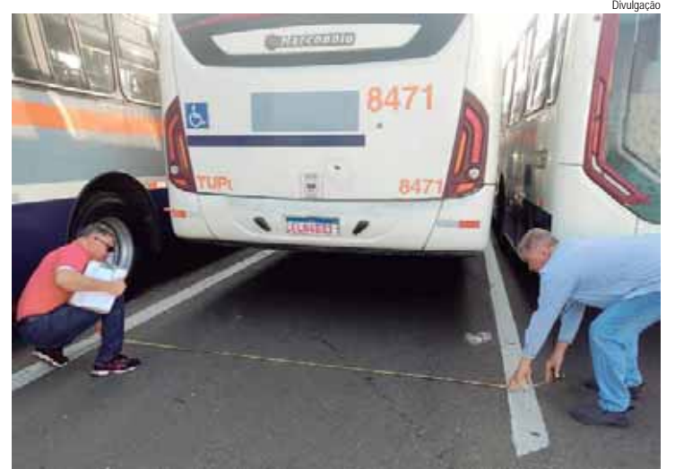
Os dirigentes do Sindicato conferiram com uma trena que a largura das baias chega a ser de apenas 2,77 metros de largura, enquanto que os ônibus têm 2,60 metros de largura
